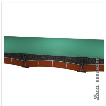
5. Izolacja akustyczna min. 2 cm
